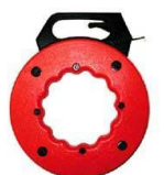
Guia c/Carrete de 15 mtos. p/Cable
